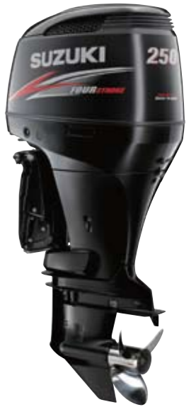
DF250 FYRTAKT Multi Point sekv. elektronisk bränsleinsprutning Max. effekt: 184 kW Cylindrar: V6 Slagvolym: 3614 cm 3 (Finns även med motsatt rotationsriktning)
