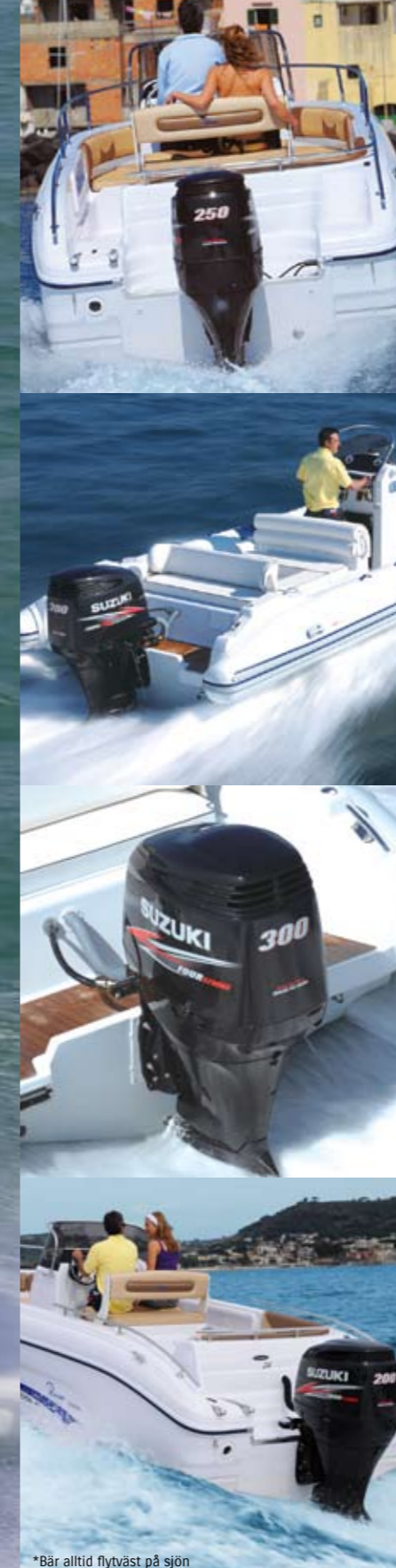
DF300 FYRTAKT Multi Point sekv. elektronisk bränsleinsprutning Max. effekt: 220,7 kW Cylindrar: V6 Slagvolym: 4028 cm 3 (Finns även med motsatt rotationsriktning)
