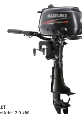
DF2.5 FYRTAKT Max. effekt: 1,8 kW Cylindrar: 1 Slagvolym: 68 cm 3
