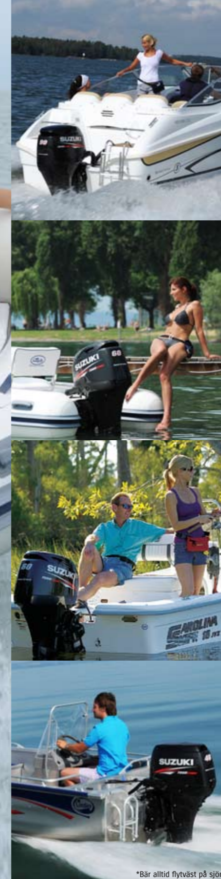
DF90 FYRTAKT Multi Point sekv. elektronisk bränsleinsprutning Max. effekt: 66,2 kW Cylindrar: 4 i rad Slagvolym: 1502 cm 3
