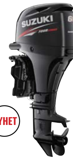
DF60 FYRTAKT Multi Point sekv. elektronisk bränsleinsprutning Max. effekt: 44,1 kW Cylindrar: 3 i rad Slagvolym: 941 cm 3
