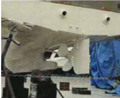
Bockarna ska vara sammankedjade för att undvika att de glider.
