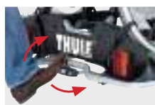
Fotmanövrerad tiltfunktion Enkel, fotmanövrerad tiltfunktion förenklar åtkomsten av bagageutrymmet.
