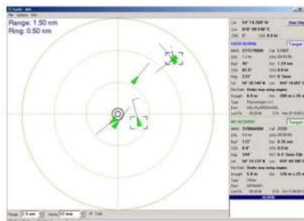
Bild 43 Exempel på hur AIS presenteras på AIS Yacht.
