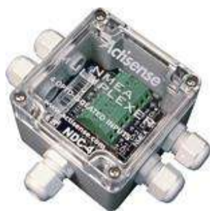
Bild 10 Multiplexer NDC-4 för att få in data från fler källor än då endast en port finns tillgänglig.
