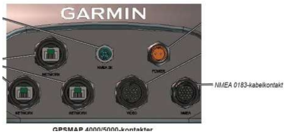
Bild 15 Inkoppling till en Garmin 4000/5000
