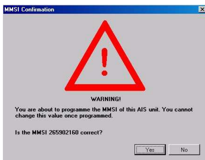
Bild 20 Innan AIS-CTRX programmeras kommer alltid denna varning upp för att säkerställa att rätt MMSI nummer har programmerats.
