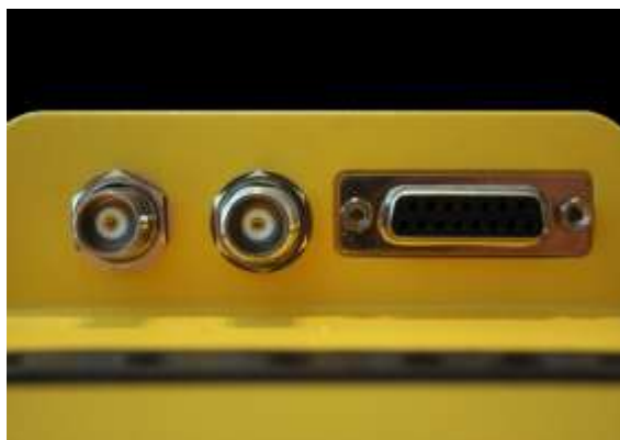
Bild 6.1 AIS-CTRX kontaktdon innanför locket. Från vänster BNC (Hona) för VHF antenn, TNC (Hona) för GPS antenn och 15 polig d-sub kontakt (Hona) för data och DC matning.
