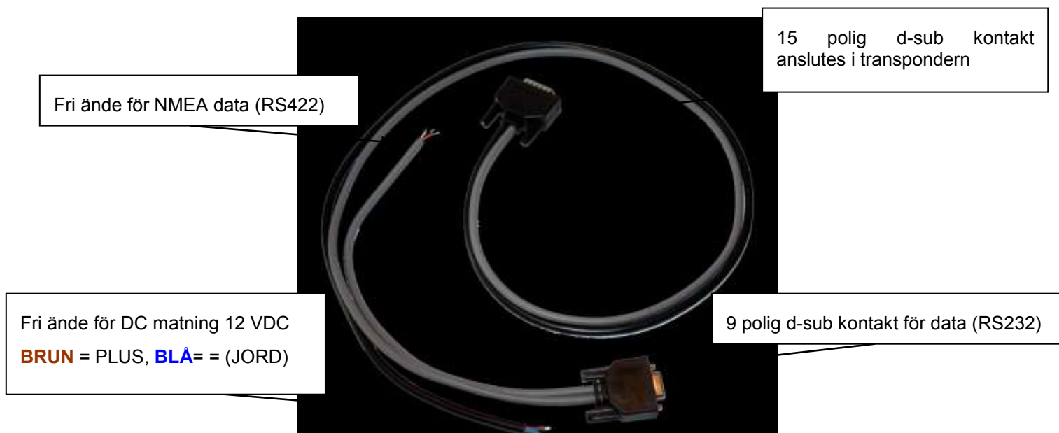
Bild 7 AIS-CTRX data och DC kablage
