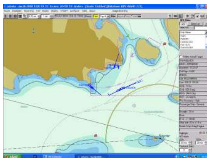
Bild 40 Exempel på hur AIS presenteras i sjökortsprogrammet ADVETO AECDIS.
